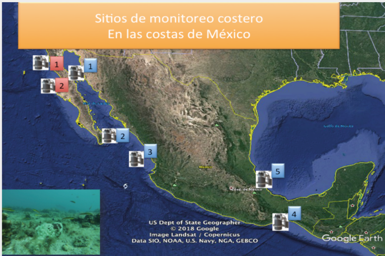
Figura C4.1. En los sitios marcados en azul la comunidad científica de expertos en arrecifes realiza mediciones continuas y discretas de variables del carbono para estudiar el tema de la acidificación. Por otro lado, en rojo se indican los sitios donde se estudia las condiciones del medio ambiente de la química del carbono en sitios donde se practica la acuicultura: (1) Bahía Todos Santos y (2) Isla Natividad. En los sitios marcados se han instalado instrumentos conocidos como SEAFET y SeapHOx los cuales miden variables como pH, temperatura, salinidad y oxígeno.
